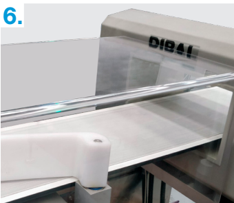
Cerramiento con túnel de metacrilato desde la salida del arco detector hasta el final del equipo para evitar manipulaciones en el producto tras el proceso de detección.
